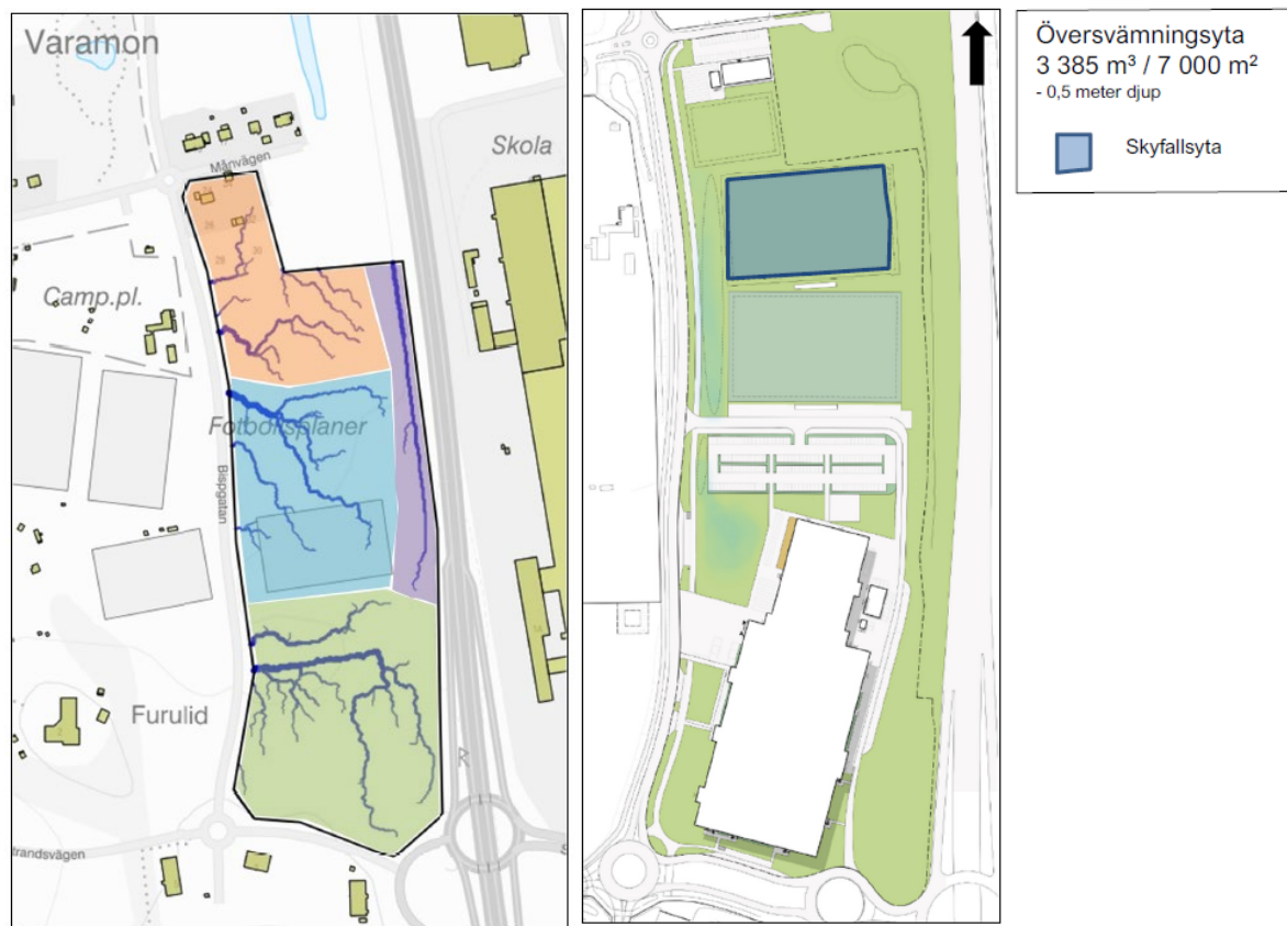
Befintliga lågpunkter och rinnvägar. Källa: Lektus
